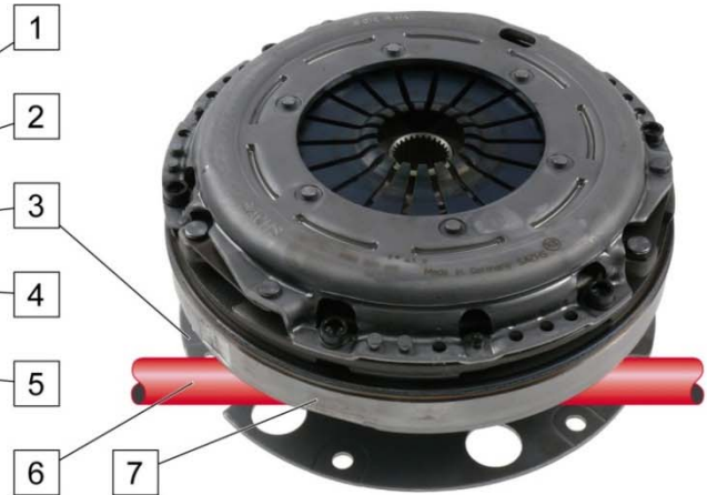
Sl. 2: Spojka, dvomaseni zamašnjak (7) i pogonsko vratilo (6)
