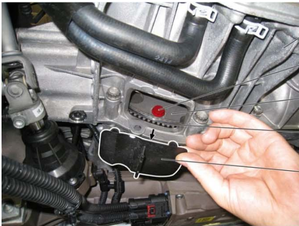
Sl. 1 Demontaža pokrova (5)
