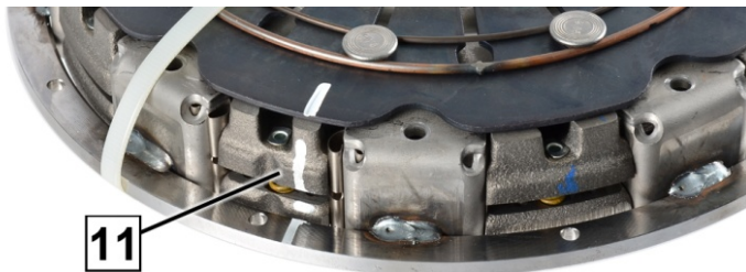
Fig. 6: Marquage au niveau du carter d'embrayage
