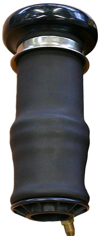
Sl. 1: Zamijenjena zračna opruga 557 001
