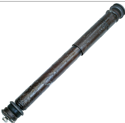
Fig. 3: Pintura de base / cera anti corrosión
