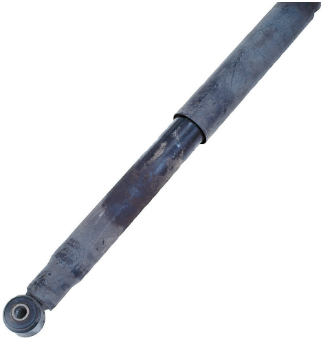
Fig. 1: Ölnebel am Stoßdämpfer
