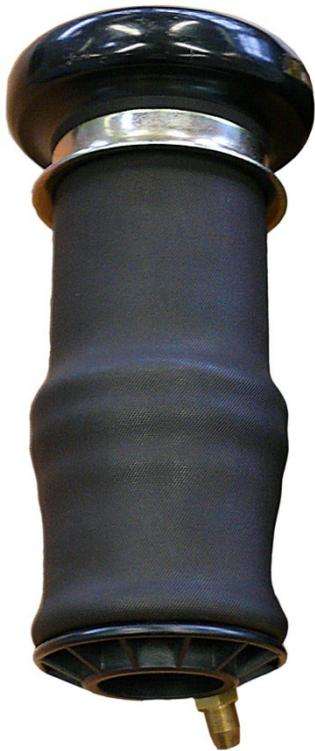
Рис. 1: Замененная пневматическая рессора 557 001
