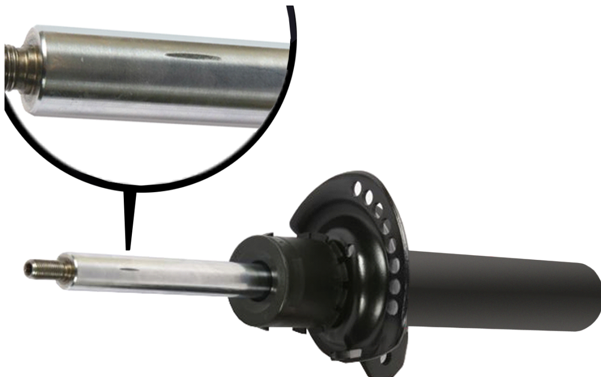
1. Ábra: Hornyos dugattyúrúd
