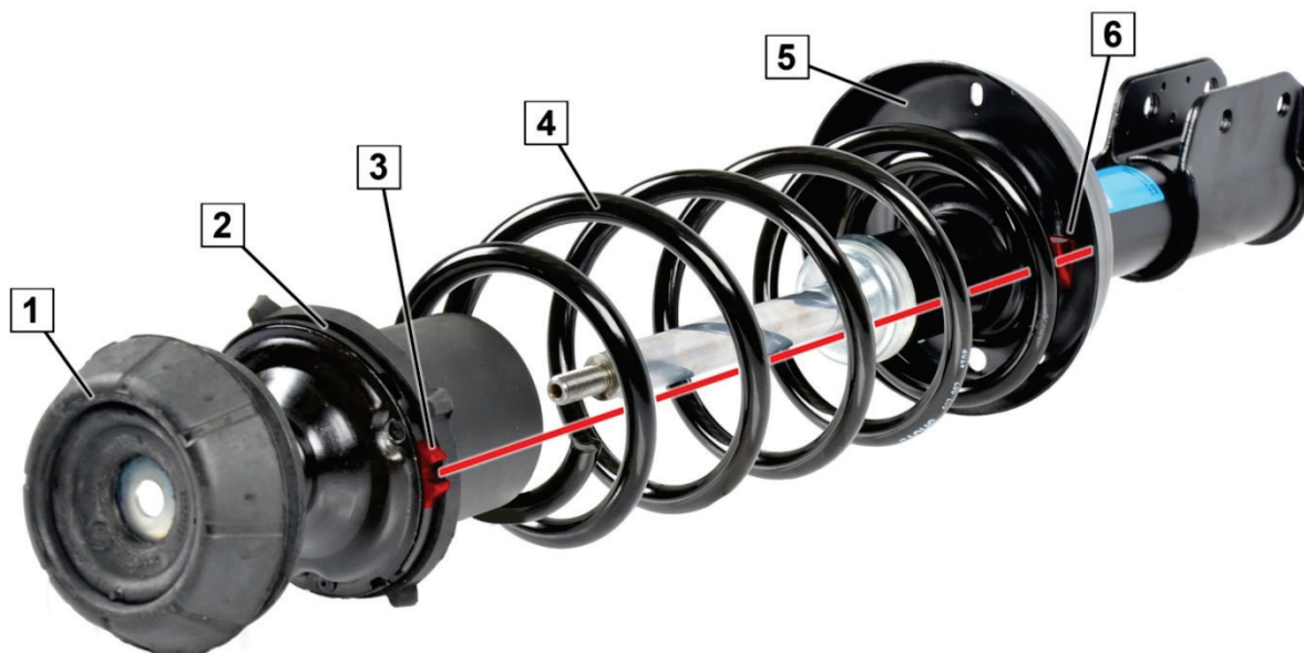
Obr. 1: Správně nastavená poloha opěrného ložiska pružící jednotky
