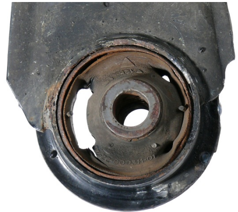
Fig. 3: soporte de goma-metal defectuoso
