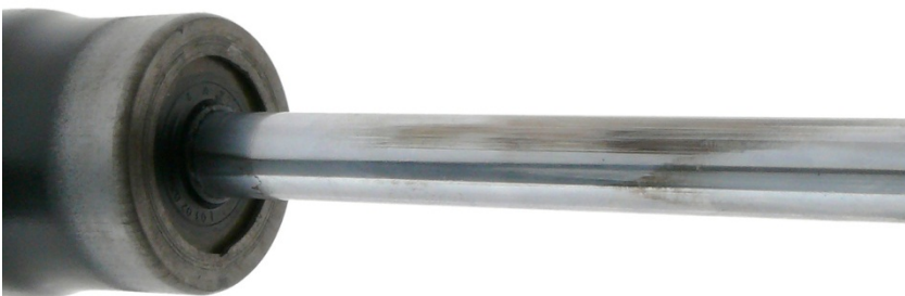
Fig. 2: capa de cromo de la biela gastada de un lado por elemento bajo torsión
