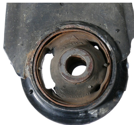
Sl. 3: Poškodba gumijasto-kovskega ležaja
