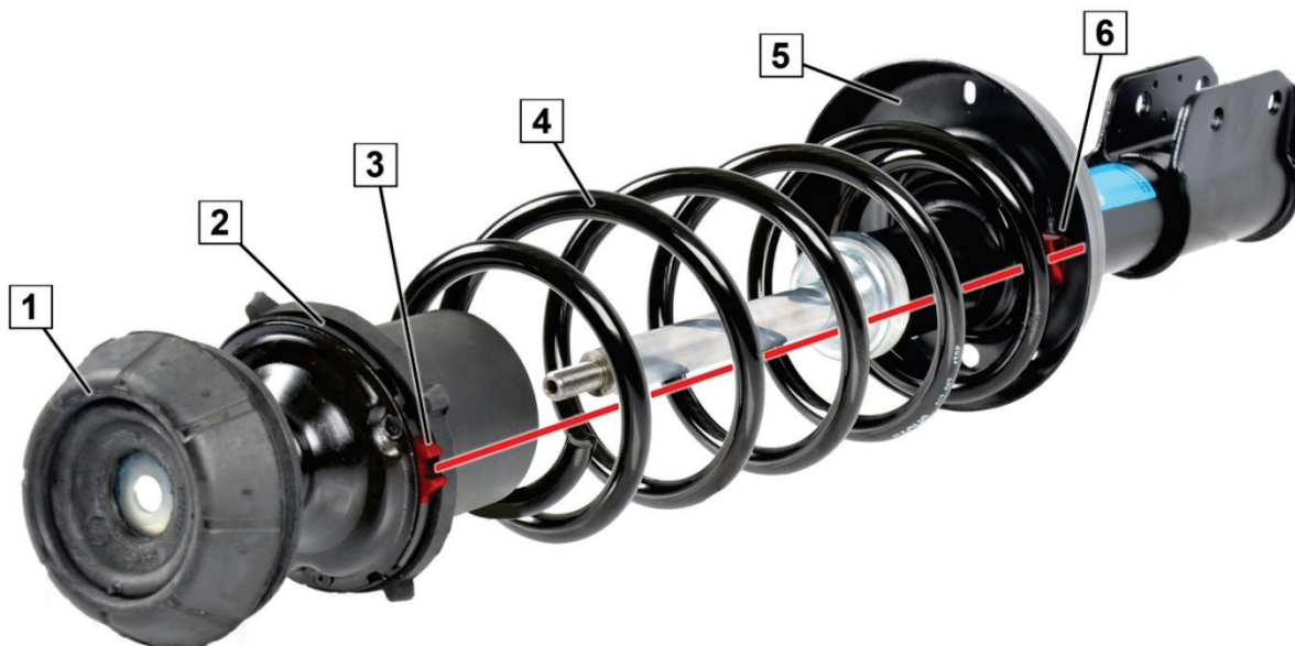
Obr. 1: Správne polohované tlmiace ložisko
