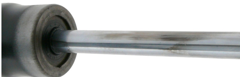
Sl. 2: Sloj hroma na klipu amortizera jednostrano istrošeno usled ugradnje pod naponom
