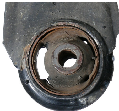
Sl. 3: Gumeno-metalni ležaj neispravan
