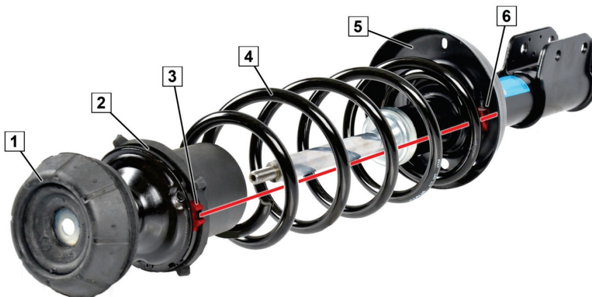
Рис. 1: Корректное размещение верхней опоры амортизационной стойки
