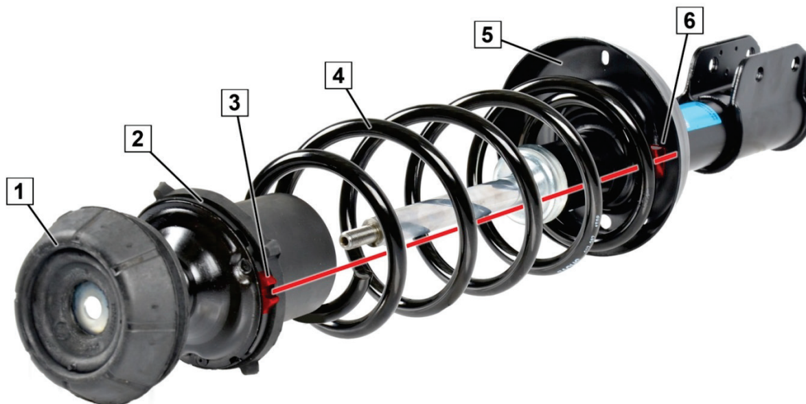
Fig. 1: Poziționarea corectă a rulmentului de sarcină
