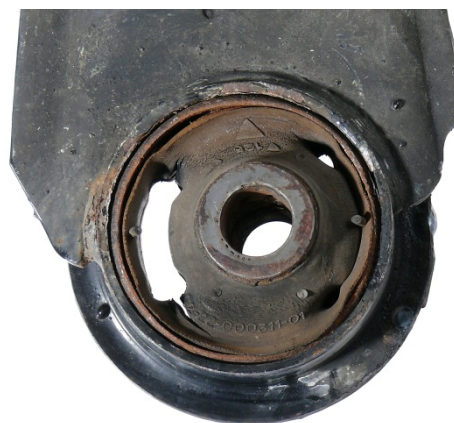
Fig. 3: Apoio de borracha-metal estragado
