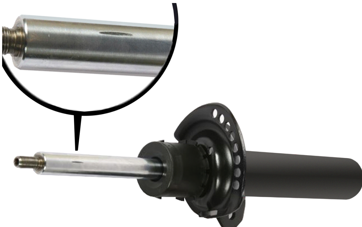
Rys. 1: Tłoczysko z rowkiem
