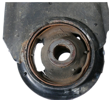
Sl. 3: Gumeno-metalni ležaj neispravan
