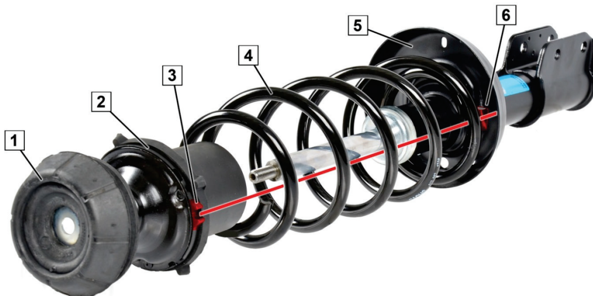
Fig. 1: Cuscinetto di supporto per l'ammortizzatore posizionato in modo corretto.
