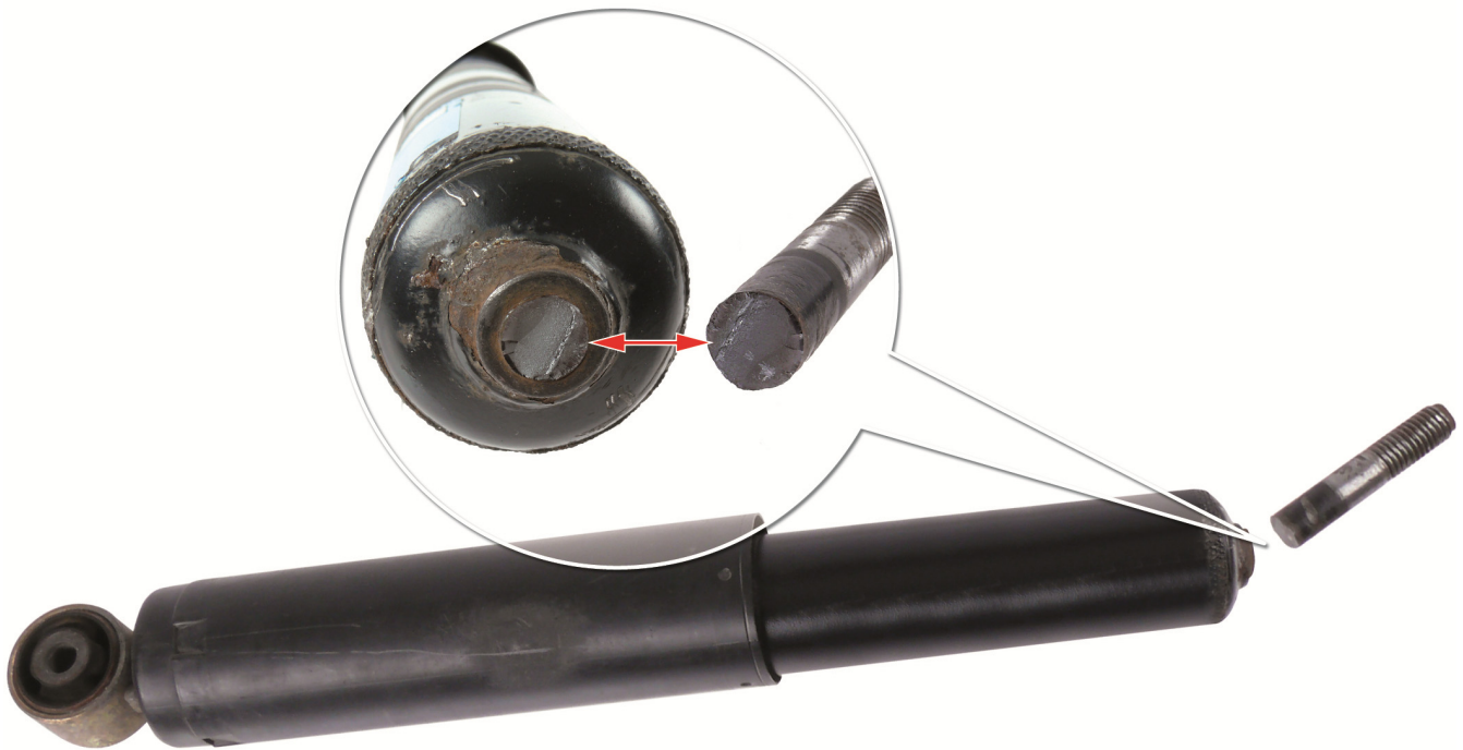
Fig. 1: Articulation de broche rompue par une charge de flexion changeante
