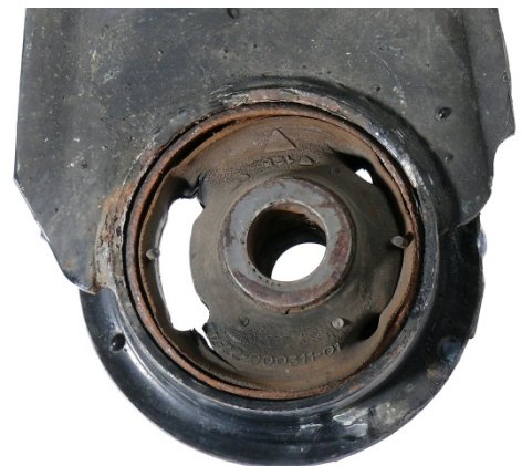
Fig. 3: Palier métallo-caoutchouc défectueux
