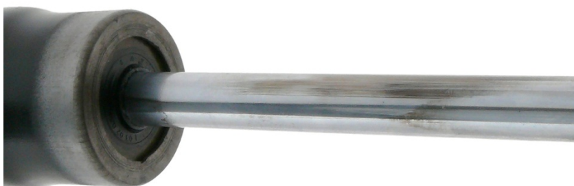
Fig. 2: Stempelstangens krombelægning slidt ned i den ene side som følge af spændt montering
