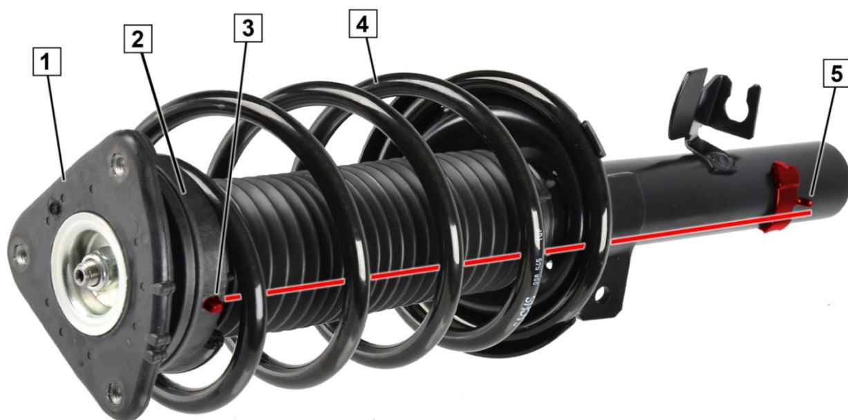
Afb. 1: Fjederbenslejet korrekt anbragt
