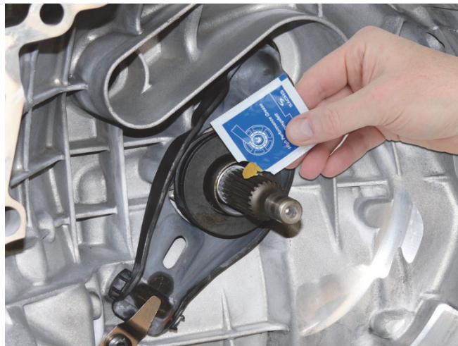
2. ábra: A hajtómű bemenőtengelye agyprofiljának enyhe körkörös beszírozása
