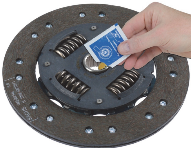
1. ábra: A tengelykapcsoló-tárcsa agyprofiljának enyhe körkörös beszírozása
