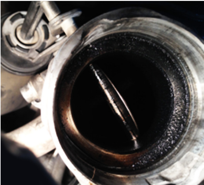
4. ábra: A kipufogógáz-visszavezető szelep (AGR-szelep) csappantyúja kókszol
