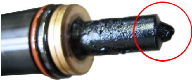
3. ábra: elkokszolódott szivattyú - porlasztófej elem
