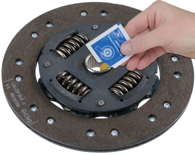
Şek. 1: Debriyaj diskinin freze işlemeli yüzeyleri gresleyin
