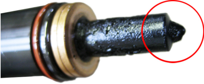
Resim 3: Enjektör memesi kurumlanmış
