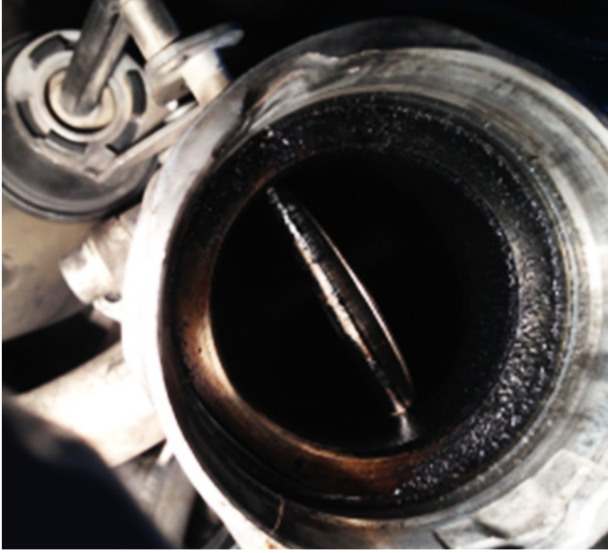
Resim 4: Egzoz Gazı Resirkülasyon valfi (EGR valfi) kurumlanmış
