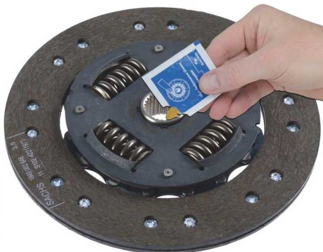
Obr. 1: Profil náboje kotouče spojky lehce namažte kolem dokola
