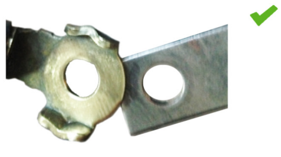
Obr. 2: Uzemnění po vyčištění: Dobrý kontakt
