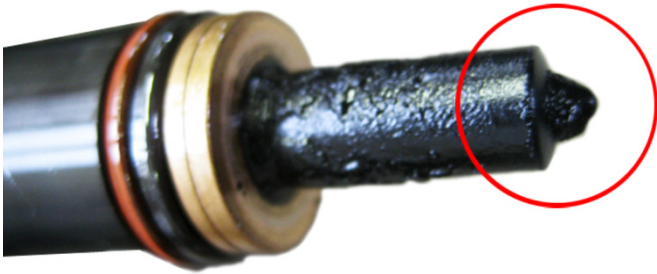
Obr. 3: Zakarbonovaný prvek čerpadlo-tryska
