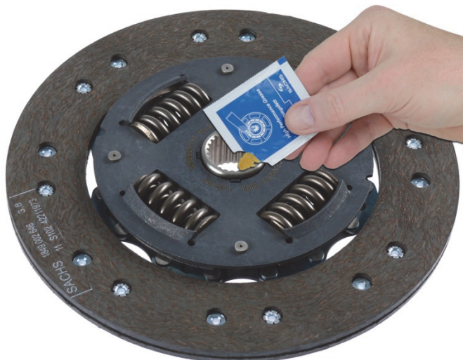
Sl. 1: Stranski profil lamele sklopke na tenko namažite okrog in okrog.
