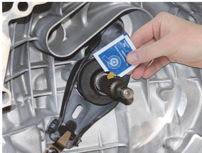
Sl. 2: Stranski profil vhodne gredi menjalnika na tenko namažite okrog in okrog.
