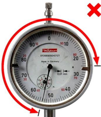
Obr. 3: Bočné hádzanie \geq 0,5 mm
