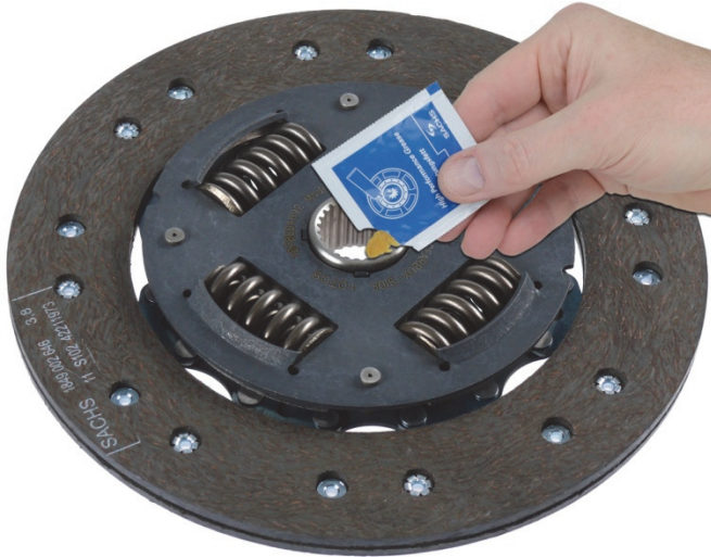
Fig. 1: Fetta in navprofilen på kopplingslamellen runt om en aning
