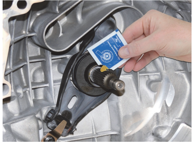
Fig. 2: Fetta in navprofilen på växellådans ingående axel runt om en aning
