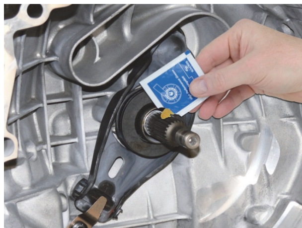
Рис. 2: Нанесение тонкого слоя смазки на шлицы входного вала коробки передач по всему периметру
