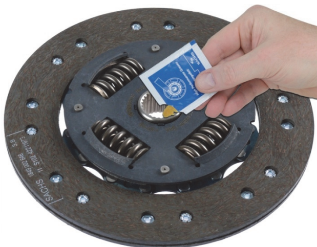
Рис. 1: Нанесение тонкого слоя смазки на шлицы ведомого диска сцепления по всему периметру
