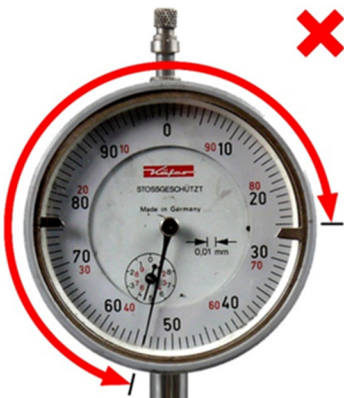
Рис. 3: Боковое биение \geq 0,5 мм
