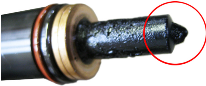
Fig. 3: Elementul duză pompă este acoperit cu calamină
