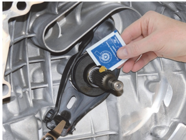
Fig.2: Untar ligeiramente o perfil do cubo do veio de entrada na caixa de velocidades a toda a volta
