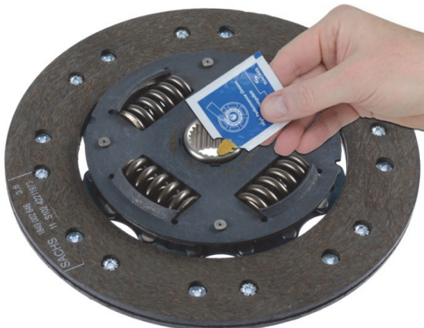
Fig.1: Untar ligeiramente o perfil do cubo do disco da embraiagem a toda a volta
