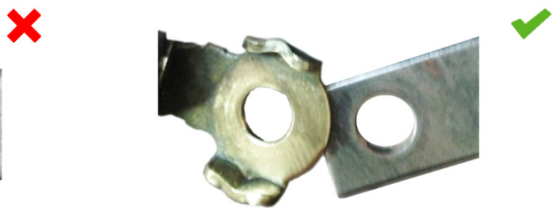
Fig. 2: Conexão da massa após a limpeza: bom contato
