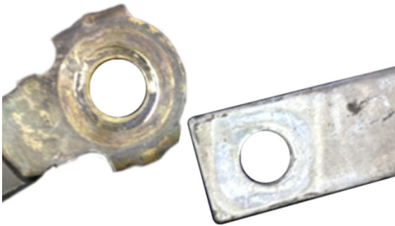
Rys. 1: Połączenie masy przed wyczyszczeniem: słaby kontakt Rys. 2: Połączenie masy po wyczyszczeniu: dobry kontakt
