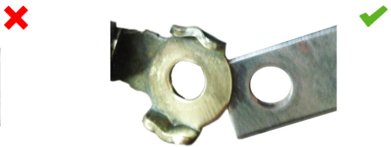
Fig. 2: Jordforbindelse etter rengjøringen: Kontakt god
