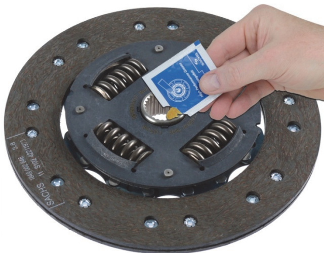
Afb. 1: Naafprofiel van koppelingsplaat rondom dun met vet insmeren
