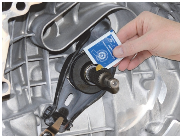
Afb. 2: Naafprofiel van ingaande as versnellingsbak rondom dun met vet insmeren
