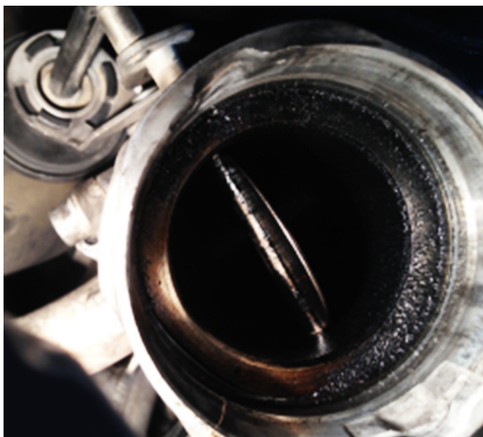
Sl. 4: Karbonizirana zaklopka ventila povratnih ispušnih plinova
