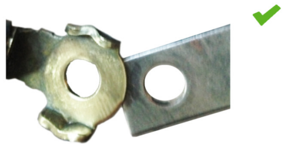
Sl. 2: Spoj mase nakon čišćenja: dobar kontakt
