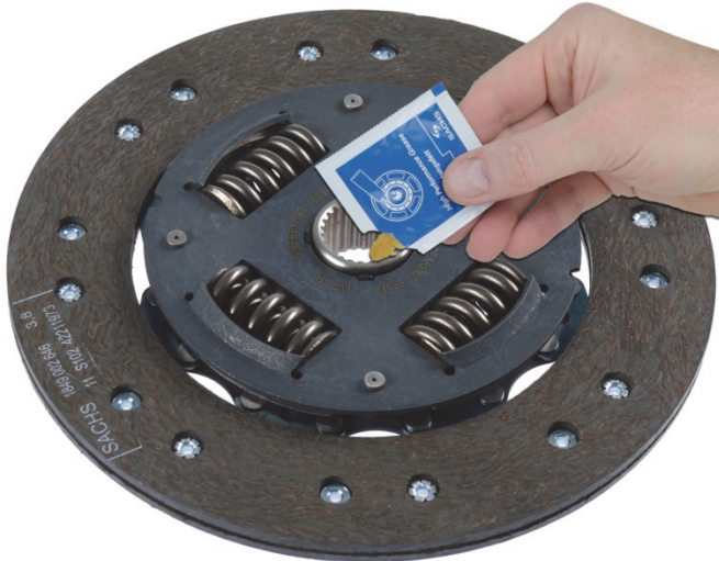
Fig. 1: Ingrassare leggermente tutto il profilo del mozzo del disco della frizione
