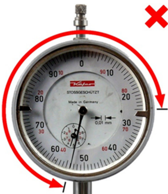
Fig. 3: eccentricità laterale \geq 0,5 mm
