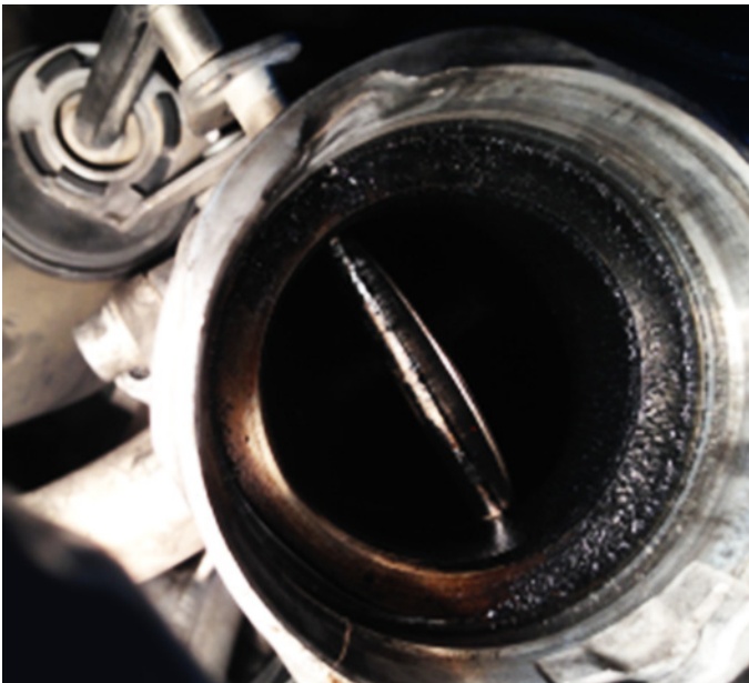
Fig. 4: la farfalla della valvola di ricircolo del gas di scarico è cokificata
