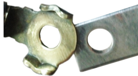
Fig. 2: collegamento di massa dopo la pulizia: contatto buono
