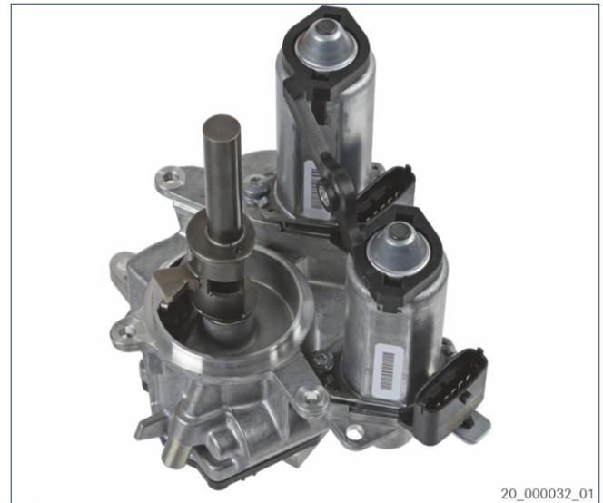
Εικ. 2: Μηχανισμός συμπλέκτη (παράδειγμα)
