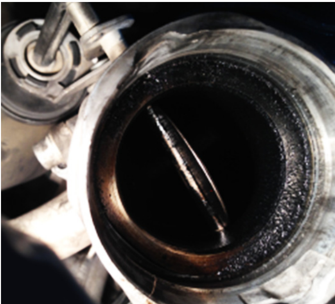
Εικ. 4: Απόθεση άνθρακα στο κλαπέτο της βαλβίδας ανακύκλωσης καυσαερίων (βαλβίδα EGR)
