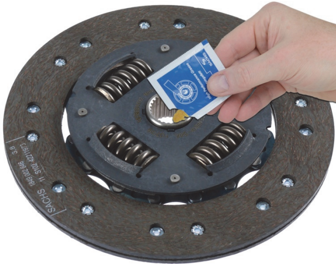
Kuva 1: Rasvaa kytkinlevyn napaprofiili ohuesti kauttaaltaan
