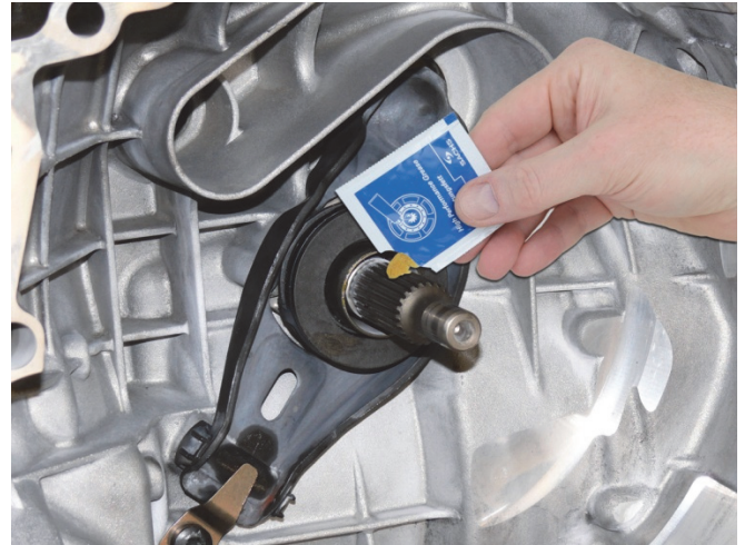
Kuva 2: Rasvaa kytkinakselin napaprofiili ohuesti kauttaaltaan
