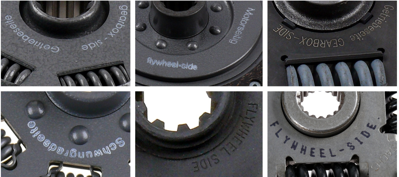
Kuva 1: Asennusasennon merkintä (esimerkkejä)
