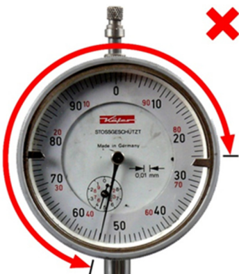
Abb. 3: Seitenschlag \geq 0,5 mm
