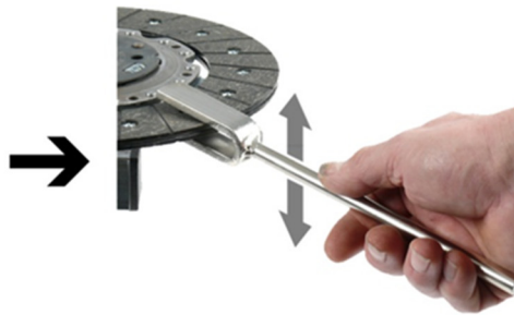
Фиг. 4: Настройка на диска на съединителя
