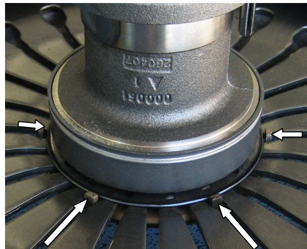
3. ábra: A rögzítő fülek oldalnézete (az összesen hat darabból csak négy látható!)
