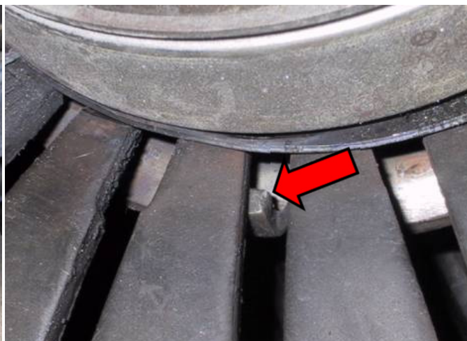
Obr. 2: Chybná poloha ložiska, zajišťovací zobáček je vyskočen z pozice mezi paprsky membránové pružiny
